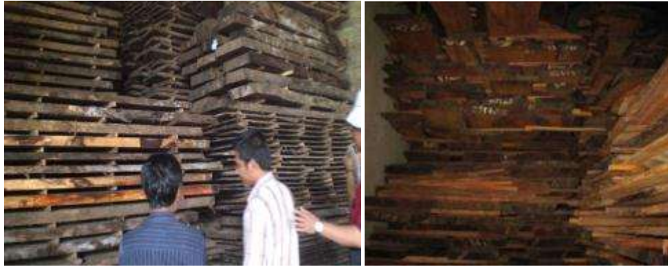
Gambar 2d. Teknik penumpukan kayu yang salah
