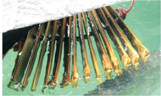
Gambar 2. Contoh uji dipasang di laut secara horizontal
